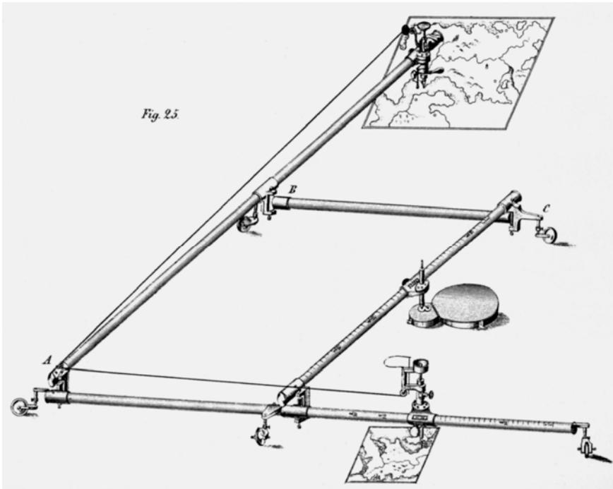
Abb. 73: Fig. 25: Pantograph von BREITHAUPT in Cassel
