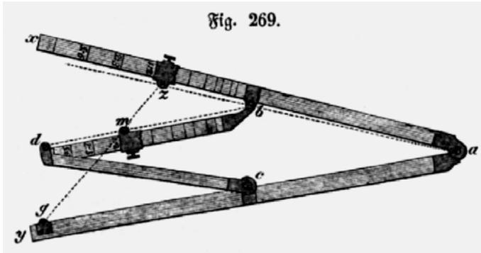
Abb. 62: Pantograph älterer Art
