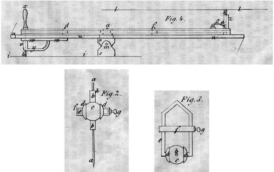
Abb. 66: Konstruktionsdetails zum Pantographen der Abb. 65
