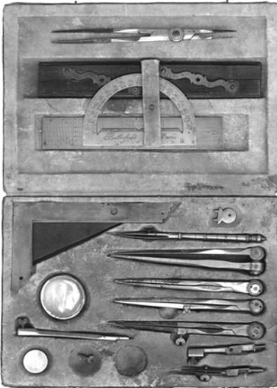
Abb. 14: Messbesteck mit unterschiedlichen Stechzirkeln, Anschlag, Winkelmesser sowie Parallel-, Proportional- und Reduktionszirkel [74]
