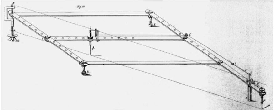
Abb. 74: Fig. 19: Pantograph von FRIEDR. HOLLER in Nürnberg
