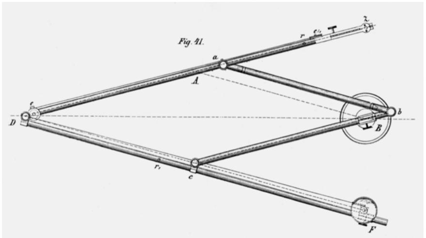
Abb. 75: Fig. 41: Pantograph von ERTL & Sohn in München
