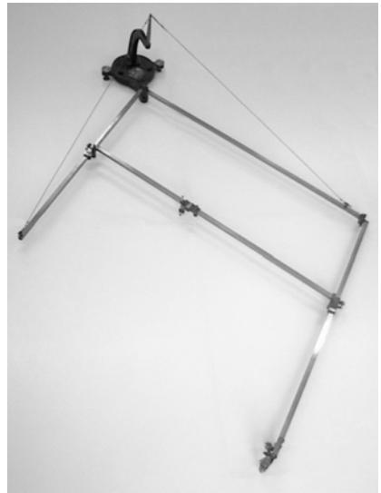
Abb. 7: Präzisionspantograph, um 1950
