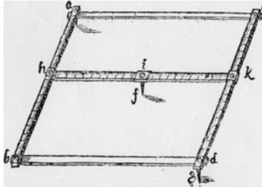
Abb. 19: Der von D. SCHWENTER betrachtete Pantograph
