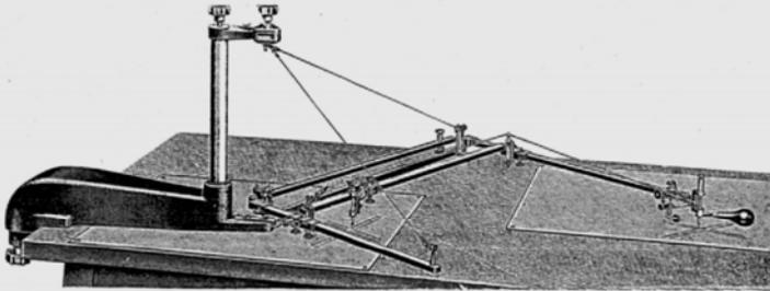
Abb. 4. Pantograph I mit Klemmfuß; Aufstellung „Pol am Ende“.
